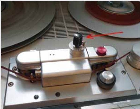
Närbild på anordningen för justering av spaltvinkel.
