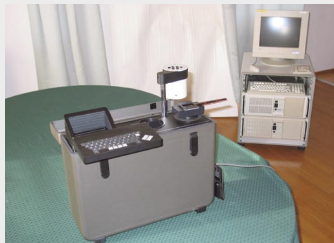
Närbild på lamphuset och filmhållaren på Dixel 2000.
